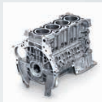
Arbetsstycke: Cylinderblock Material: Pressgjuten aluminium Mått: 350 x 410 x 230 mm Bearbetningstid: 1 min. 25 sek.
