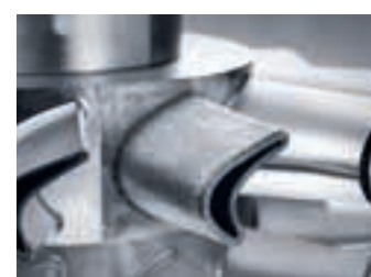
Laserpåsvetsning och fräsning av turbinkolvar
