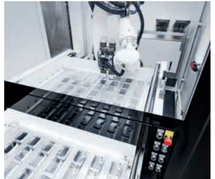
Arbetsstyckemagasinet med två skjutfack har tillräckligt med plats för långa faser utan ingripande från personalen.
