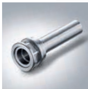
Bilindustri / insprutningsmunstycke Material: AISI 303 Storlek: ø 12,2 × 34,5 mm Bearbetningstid: 95 sek.
