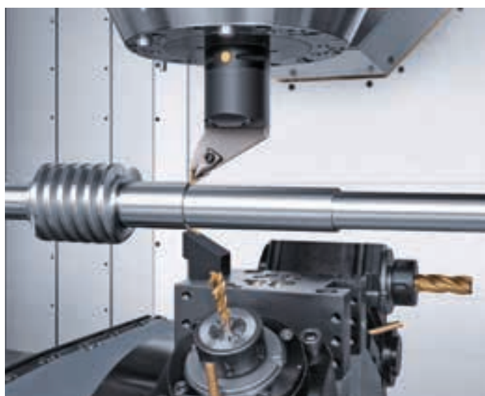
Bearbetning på 4 axlar med B-axel och nedre revolver.
