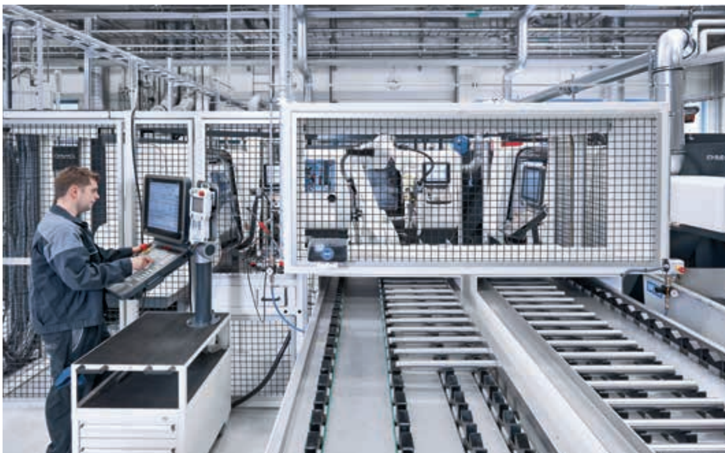
Laddning och plundring av tillverkningscellen sköts av två transportband. Den övriga processen sker helt automatiskt.
