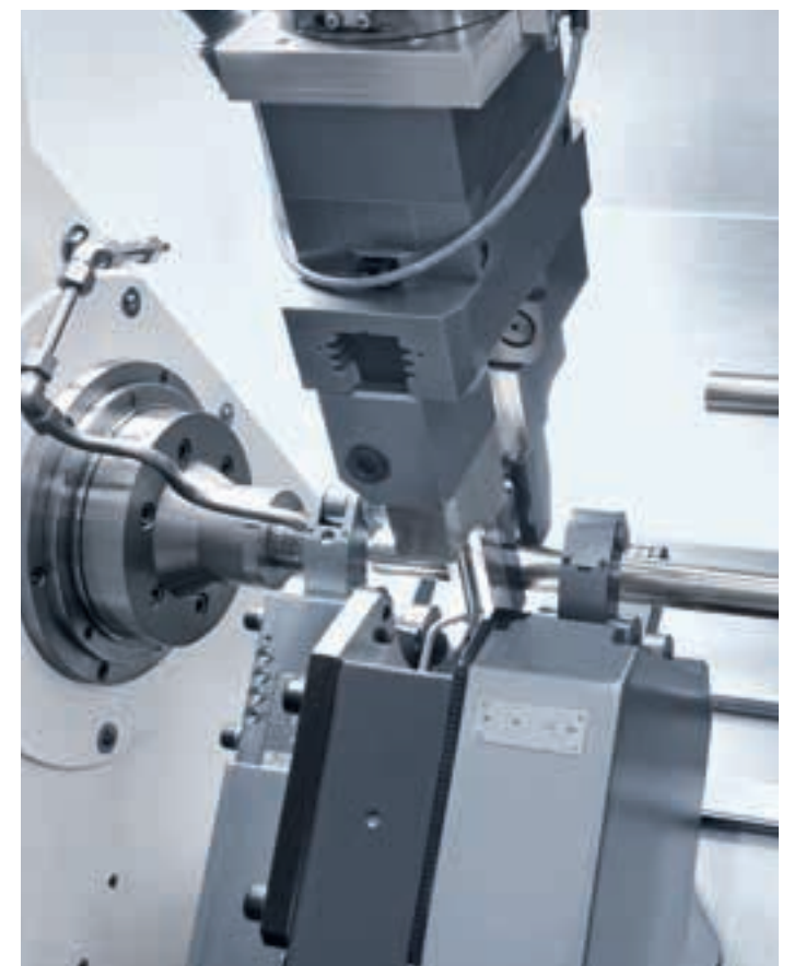
Hjälpdockan i CTX beta 800 linear används för stabilisering av arbetsstycken i samband med den avslutande spår- och hållfräsningen.
