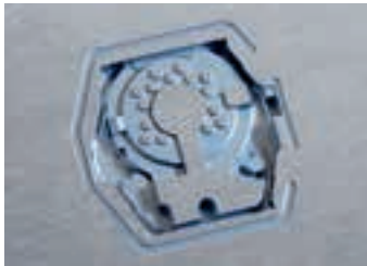
Laserbearbetning: Små kaviteter i miniatyrform
