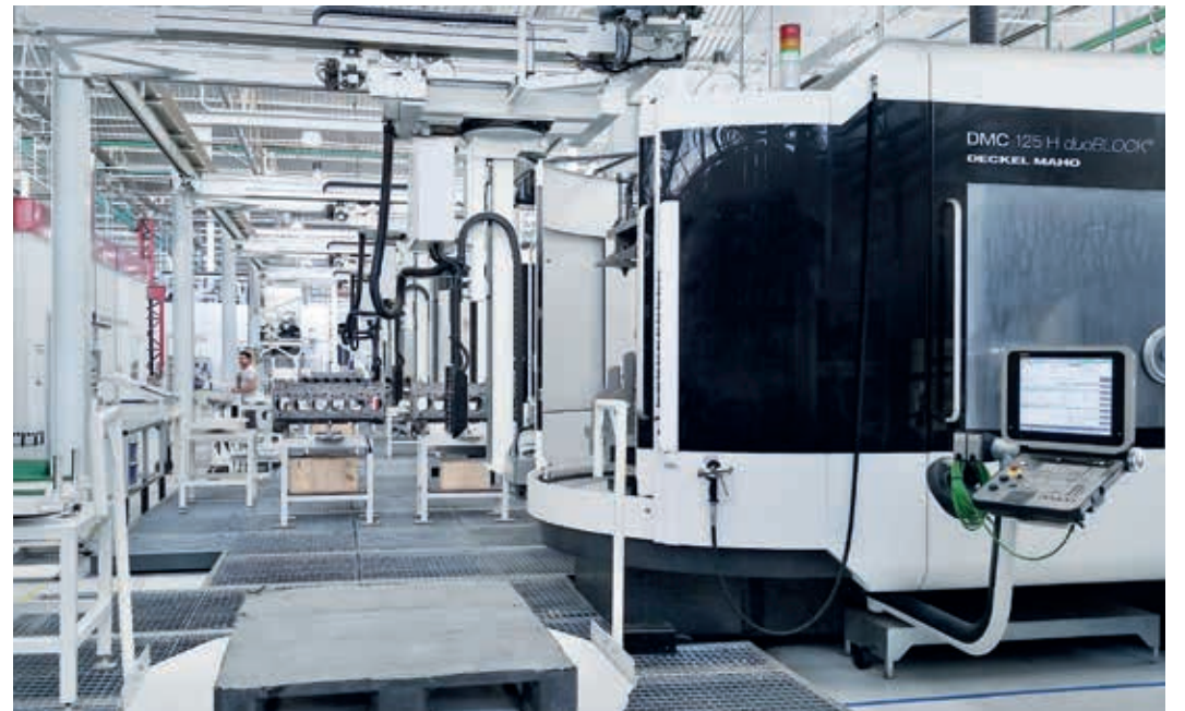
Hos FPT Industrial Argentina S.A. har DMG MORI Systems tagit fram en tillverkningslinje med totalt 13 fleroptionsmaskiner av typen DMC som ett turnkey-projekt.
