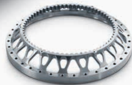
Bromslamellkammare Svarvning CTX beta 800 Fräsning DMU 80 eVo linear Material: titan Löptid: 5-axlig fräsning ca 7 timmar
