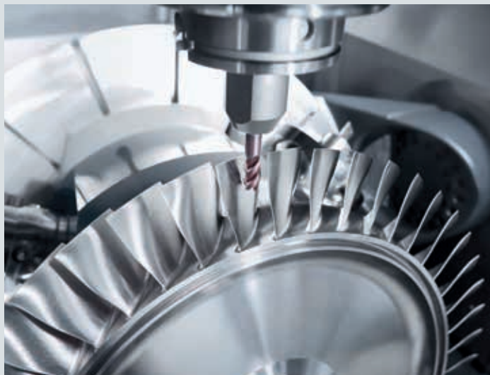
Maximal stabilitet och dynamik hos monoBLOCK®-serien utgör idealiska förutsättningar för bearbetning av turbinhjul i ett stycke.
