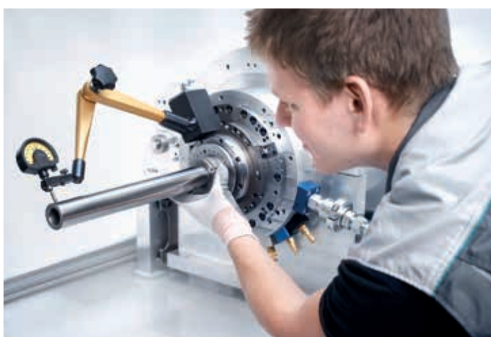
18 timmars geometrikontroll av maskin och spindlar.
