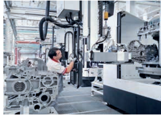
Komponenterna laddas på riggningsplatsen. I förgrunden en vrid- och vändstation.
