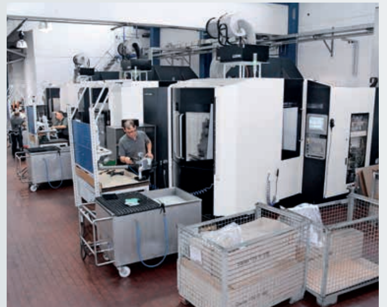
Tre nya DMC 60 H linear bearbetar parallellt krävande detaljer hos ZBG för motorcyklar på mycket kort tid och med maximal kvalitet.
