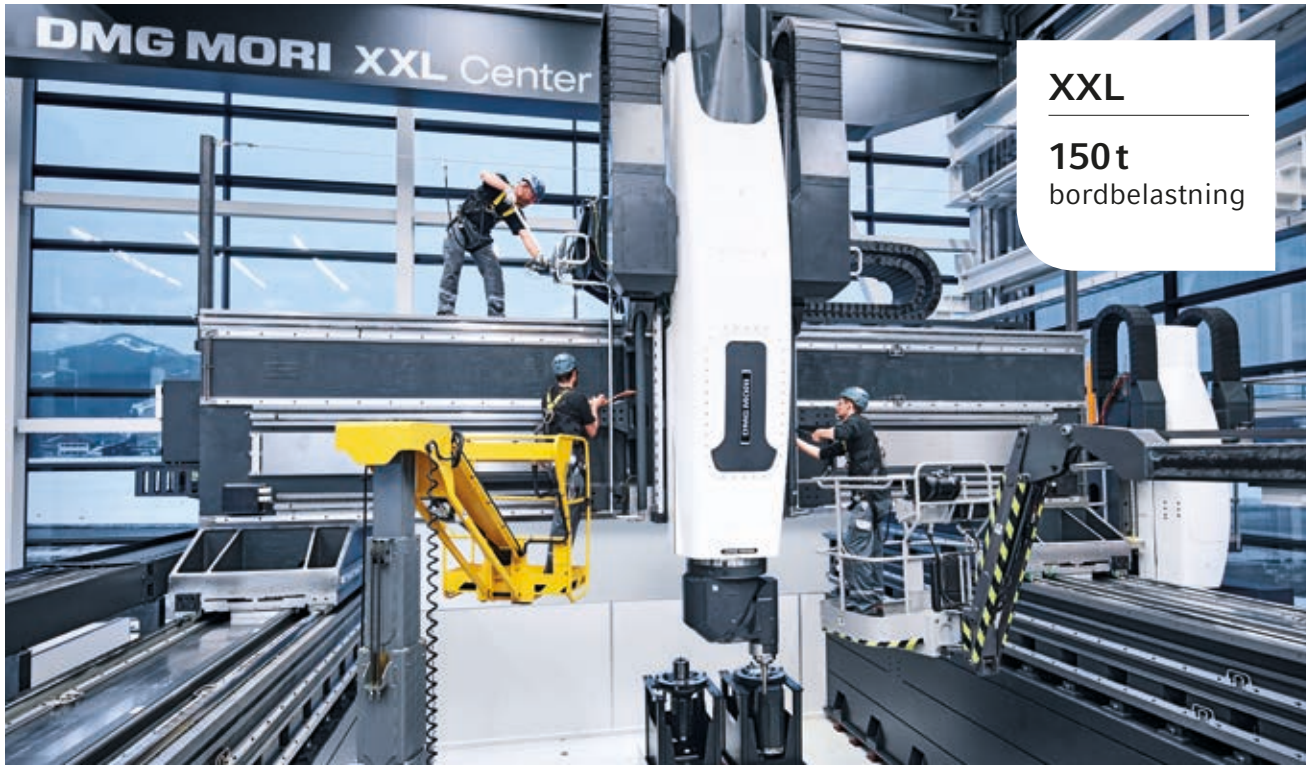
Upptill: DMU 600 G linear under montering i XXL-centret hos DECKEL MAHO i Pfronten, den modernaste stora maskinen i världen. Nedtill: konstant hög precision, tack vare maskinstrukturens temperaturstabilitet.
