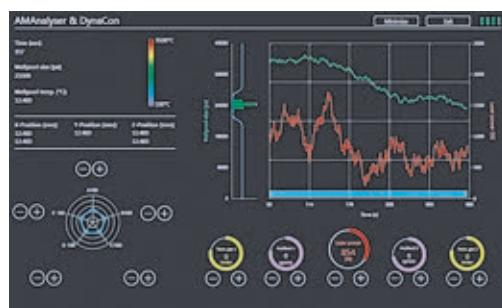
Adaptiv processkontroll Automatisk anpassning av lasereffekten.
