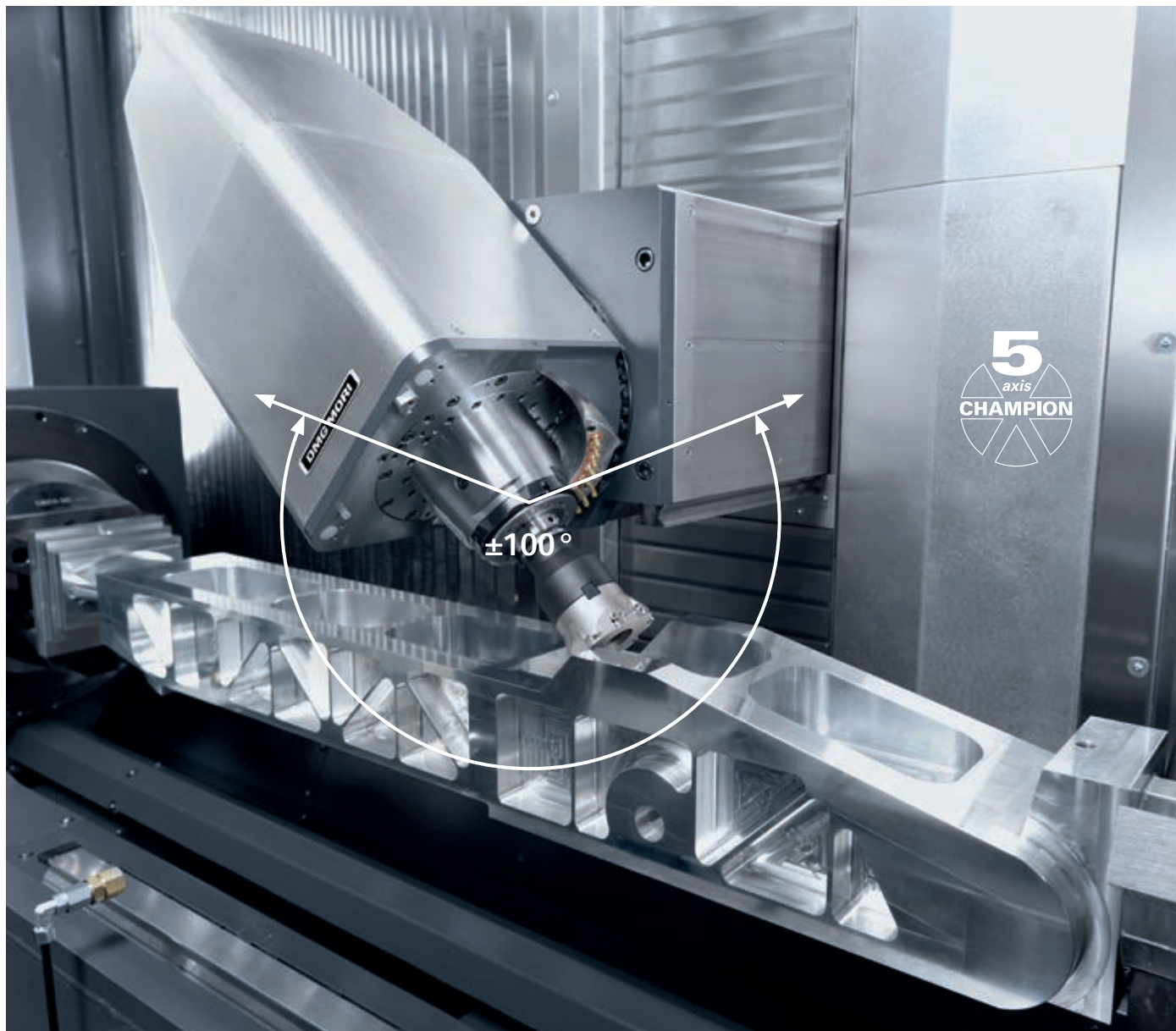
5-axlig bearbetning av ett ok i DMF 26017 med teknikram.
