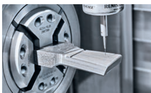
5-axlig simultanbearbetning av skärinsatser för valsskålfräs i NTX 1000.
