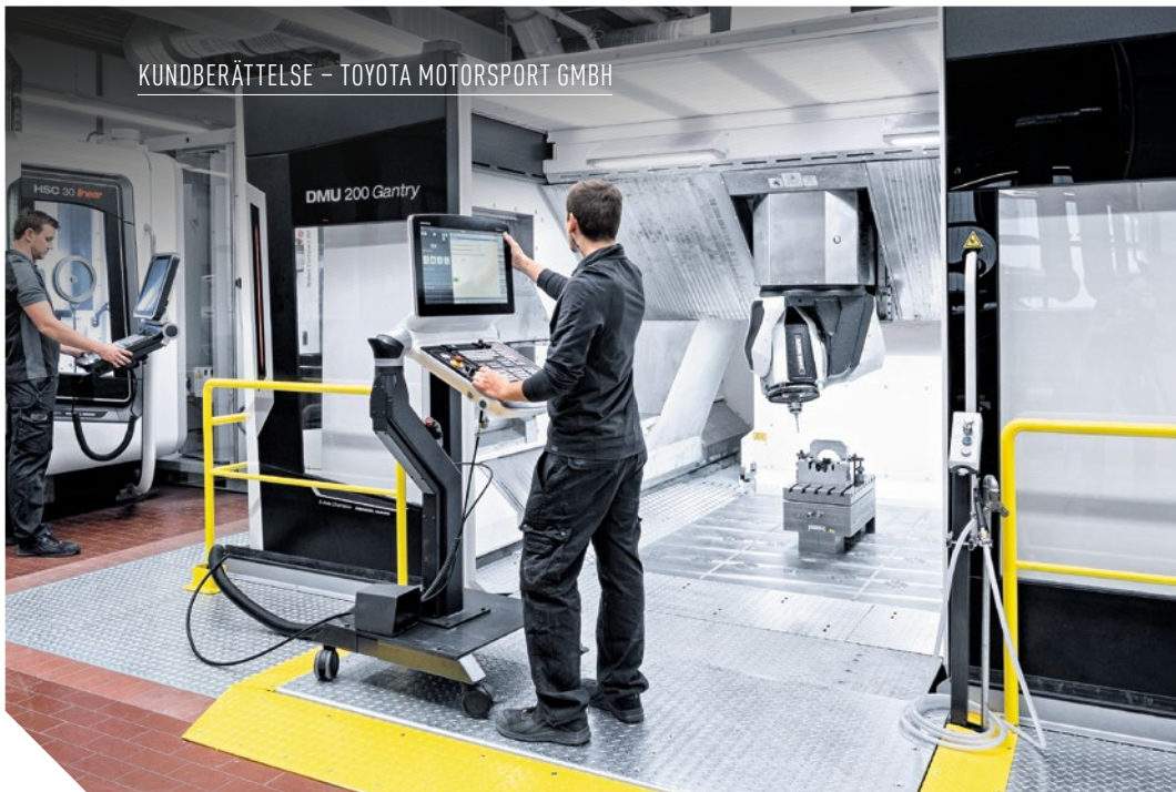
Uppställning av DMU 200 Gantry på golvnivå i en grop så att känsliga kolfiberdetaljer kan lastas in och ut med truck.
