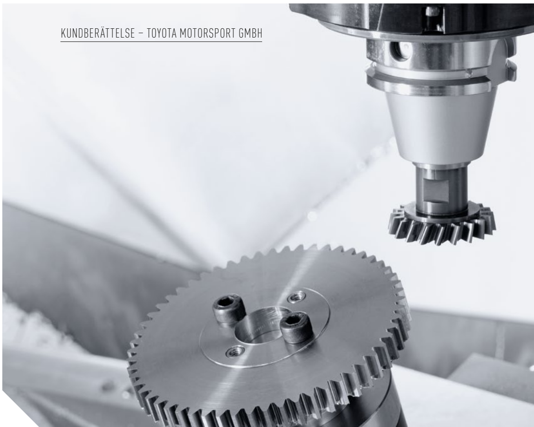
DMG MORI gearSKIVING – bearbetning av kugghjul på en DMU 60 eVo i slipkvalitet.
