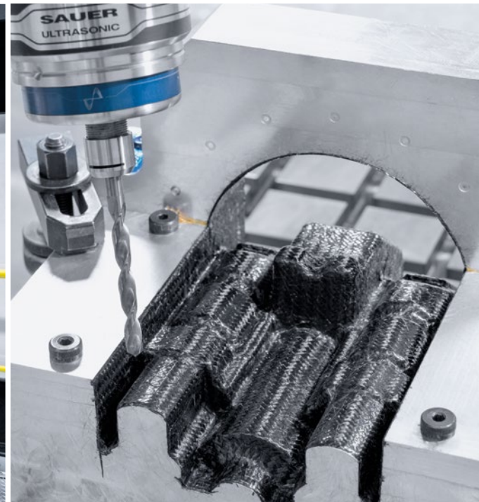
Processäker bearbetning av kompositmaterial på DMU 200 Gantry tack vare helautomatiskt utbytbar ULTRASONIC-spindel.
