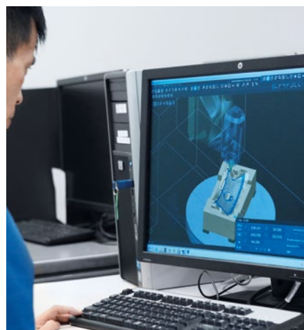
CAM-programmerare strävar efter att utveckla verktygsvägar som drar nytta av alla möjligheter med den 5-axliga bearbetningen.
