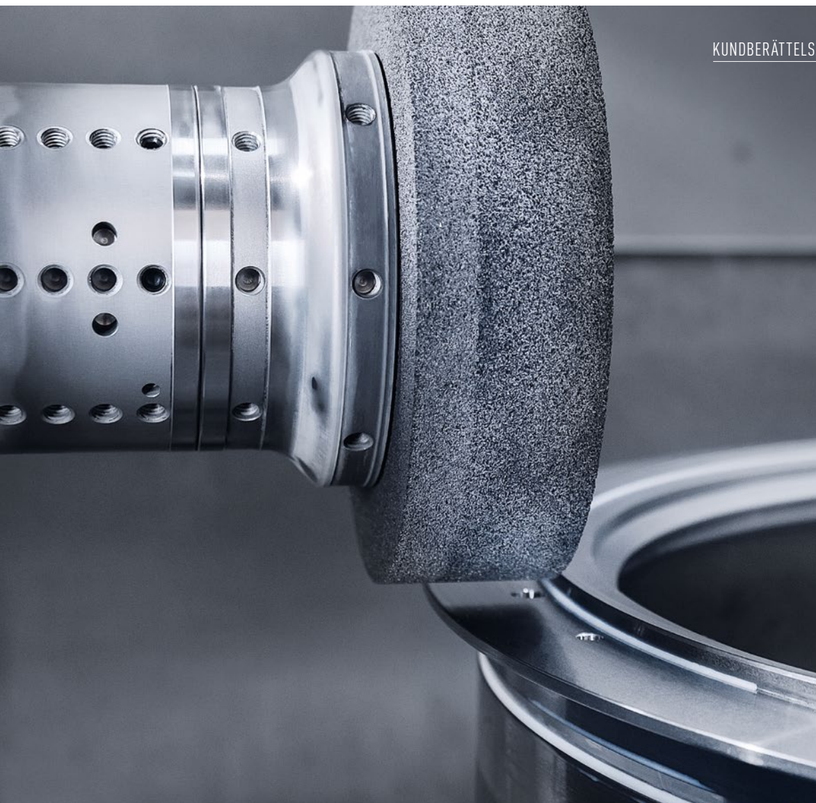
DMC 125 FD duoBLOCK inklusive slippaket möjliggör fräsning, svarvning och slipning i en och samma uppspanning.
