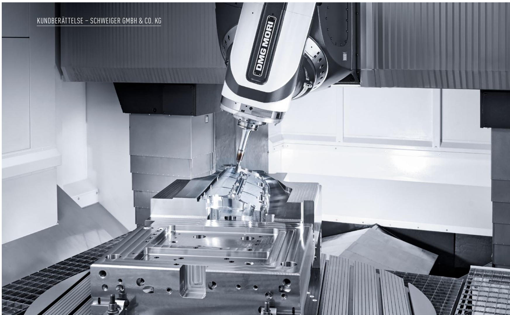
Formbearbetning med mycket hög precision på en DMU 210 P.
