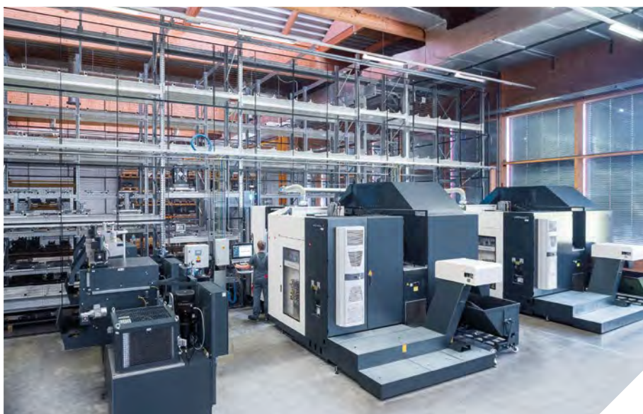
Två DMC 60 H linear är anslutna till ett palettmagasin med 100 platser. I kombination med ett verktygsmagasin med 303 platser säkerställs autonom produktion nattetid och på helger.
